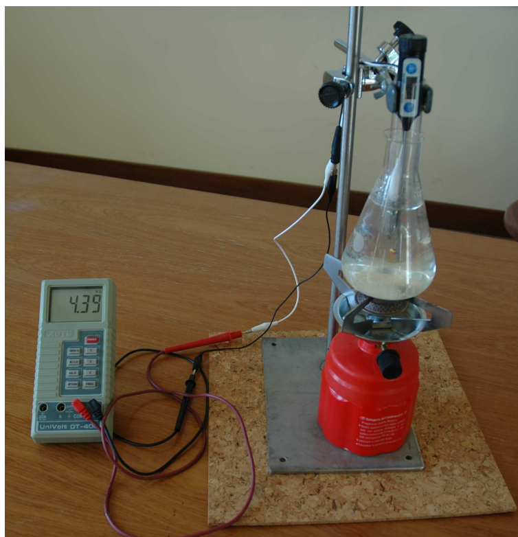
Figura 1: Montagem para a calibração do termistor.
