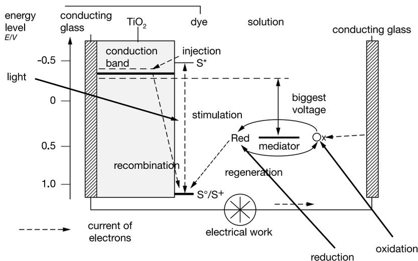
**Figure 3.** Functional diagram of the Graetzel cell (reproduced from *Entwicklung neuartiger Solarzellen auf der Grundlage Farbstoff-sensibilisierter nanokristalliner Halbleiterfilme* (1994), page 2).
