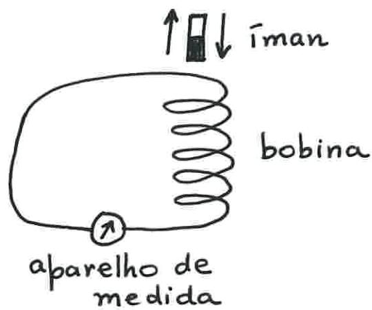
→ quando o íman se move rapidamente para dentro e para fora da bobina, é detectada uma corrente no circuito, ora num sentido, ora noutra.
